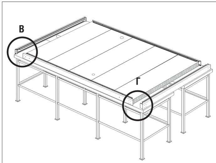
6. Убедитесь в надежности крепления алюминиевых профилей к сэндвич-панели. Снимите стяжные ремни с полотна двери и защитную пленку (картон).
