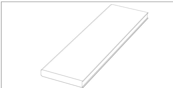
Комплект панелей полотна двери толщиной 80 или 120 мм (в зависимости от заказа). Количество панелей — согласно спецификации.
