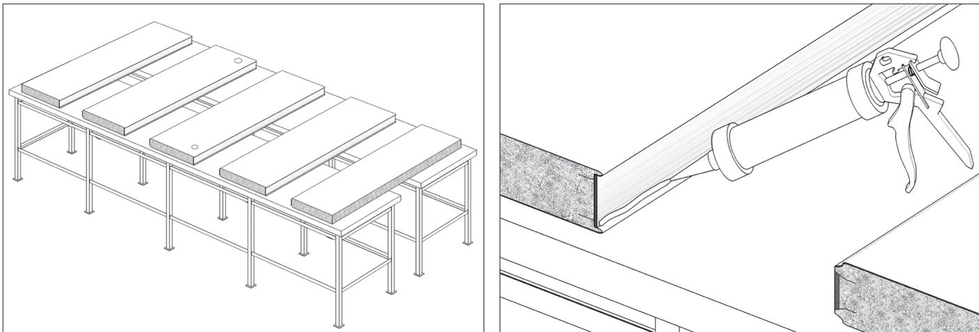
1. Состыкуйте сэндвич-панели между собой, нанося на паз силиконовый герметик. Количество панелей зависит от высоты полотна.
