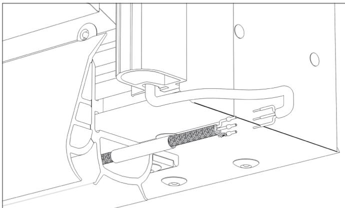
Соедините обогревающий кабель с силовым кабелем.
