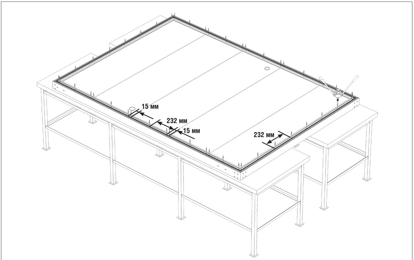
17. В просверленные отверстия  $\varnothing 4,2$  мм с определенным шагом установите заклепки  $\varnothing 4$  мм.
