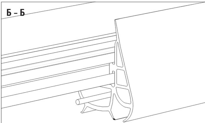
Схема прокладки кабеля обогрева в нижнем уплотнителе.
