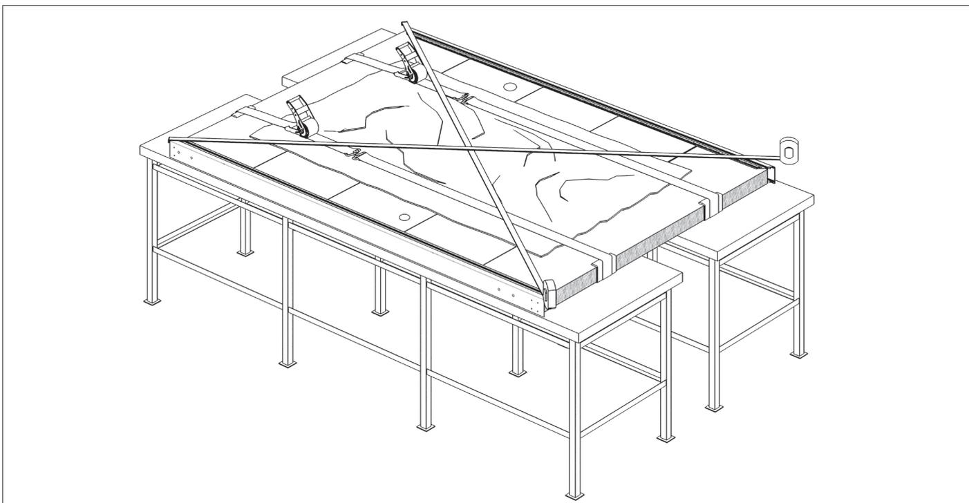
5. Замерьте диагонали полотна. Разница диагоналей не должна превышать 3 мм.
