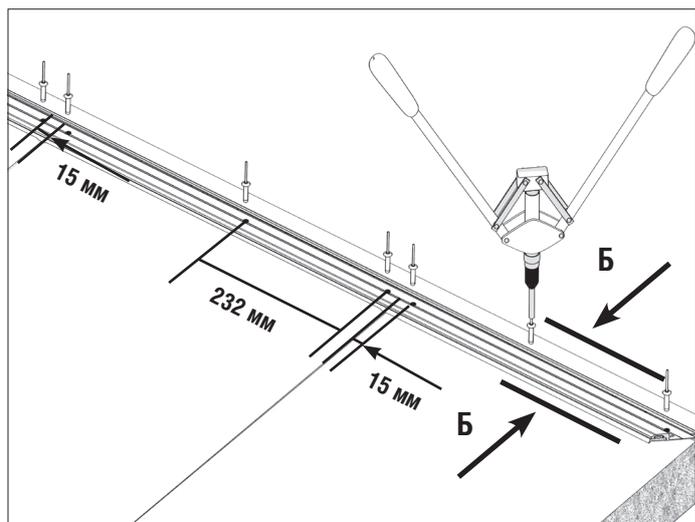
5.1. Закрепите боковые алюминиевые профили. Для этого просверлите отверстия  $\varnothing 4,2$  мм с шагом, показанным на рисунке.
