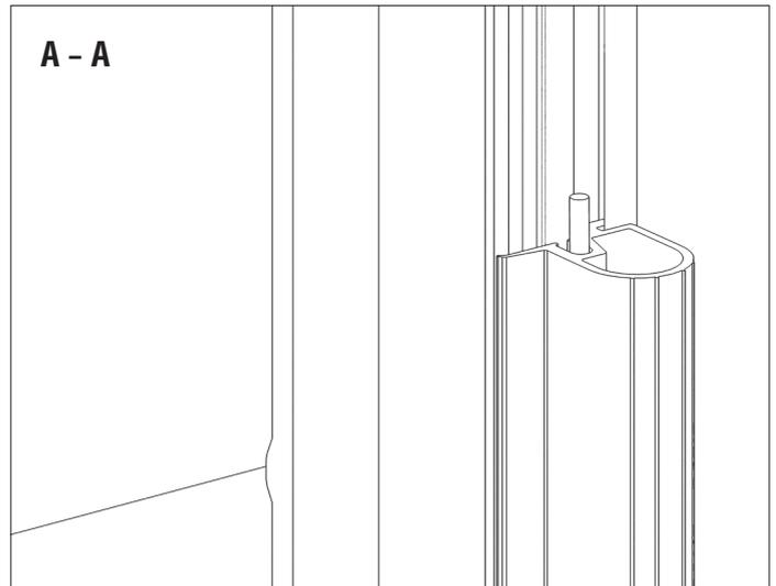
Схема прокладки кабеля питания в уплотнителе полотна.
