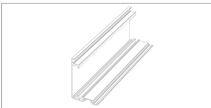
Профиль алюминиевый окантовки сэндвич-панели согласно спецификации (L — согласно спецификации, мм) (4 шт.)
