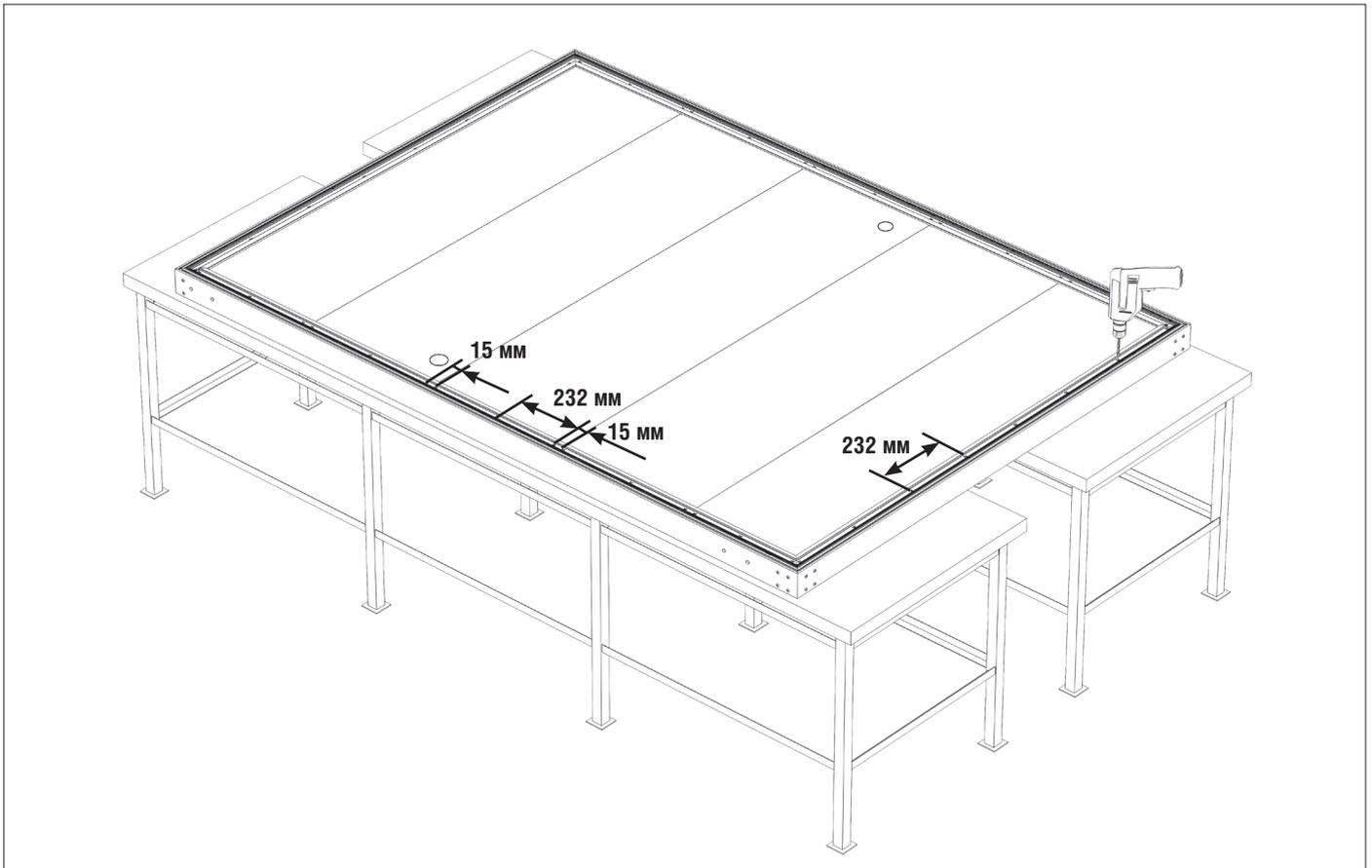
16. Закрепите комбинированный алюминиевый профиль. Для этого просверлите отверстия  $\varnothing 4,2$  мм с определенным шагом, согласно рисунку.
